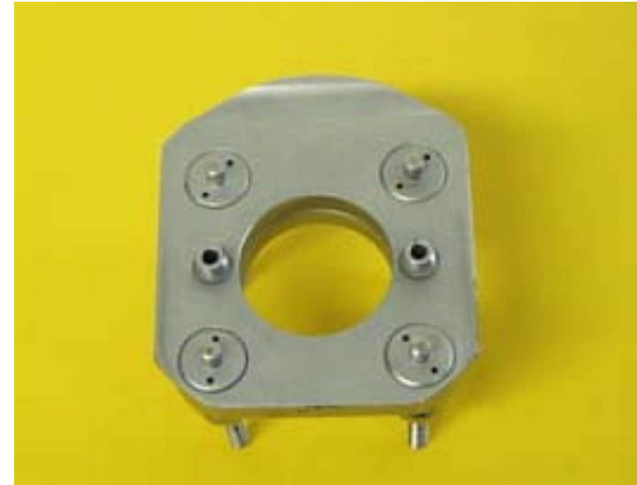
Nicht zerlegbare Küvette mit definierter Schichtdicke
