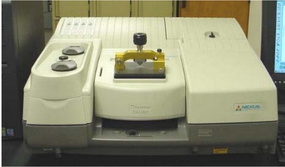
FT-IR-Spektrometer mit Golden Gate™-ATR
